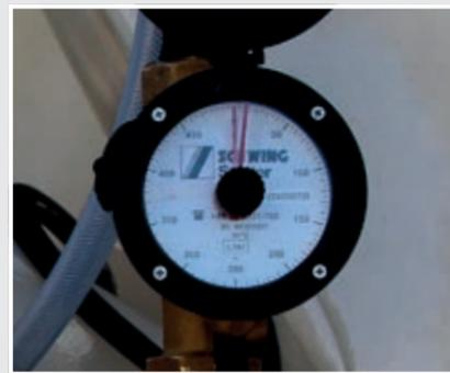
Wasseruhr zur exakten Wasserdosierung mit Skalenendwerten von 500 bzw. 1.000 l.
