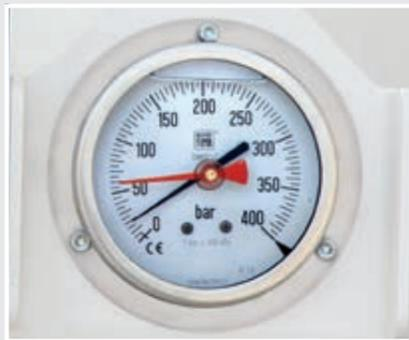
Konsistenzmanometer - zur Anzeige des Betriebsdrucks des Hydrauliksystems.
