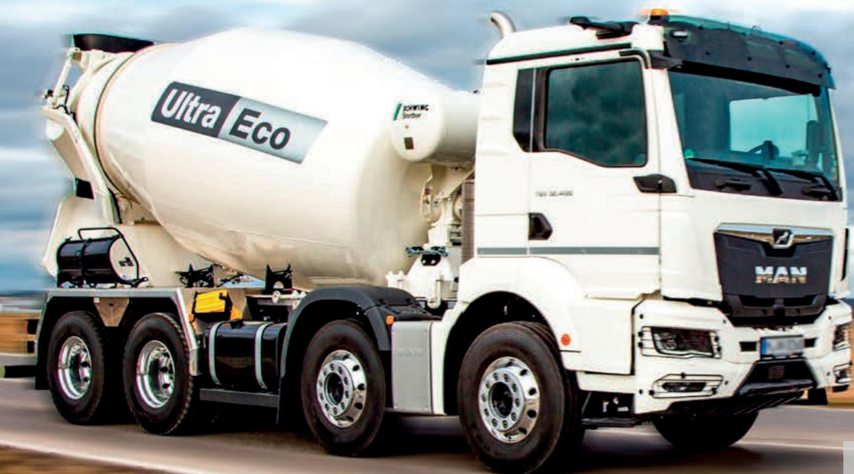
*Die neue Version des Fahrmischers UltraEco von SCHWING-Stetter bringt das Aufbaugewicht der Trommel auf unter 3 Tonnen und ermöglicht auf einem gewichtsoptimierten EURO-6 8x4-Fahrgestell somit weiterhin eine Zuladung von 8 m<sup>3</sup> Beton bei einem zulässigen Gesamtgewicht von 32 Tonnen.*
