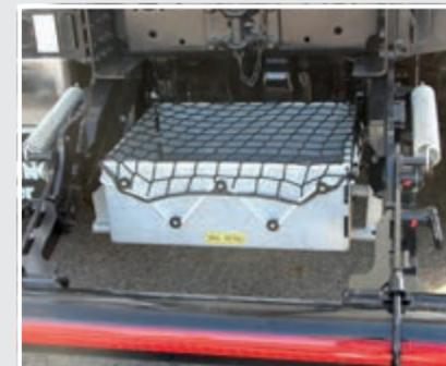
Optionale Schwerlastbox im Unterfahrerschutz integriert
