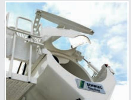
Hydraulisch schwenkbarer Einfülltrichter (erleichtert die Hochdruckreinigung der Mischtrommel)
