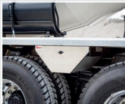
Staubbox unterhalb des Kotflügels
